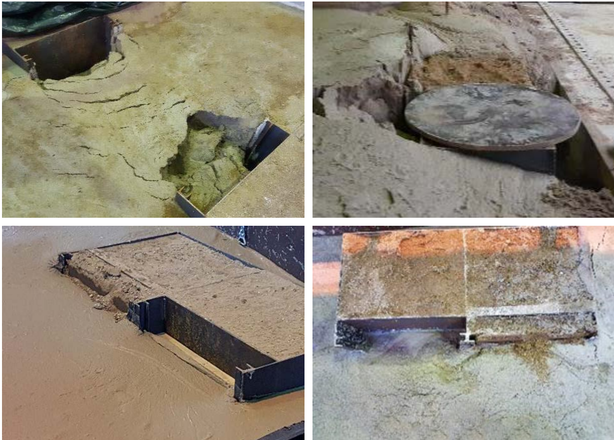
Bild 14 Bewertung des Unterkriteriums „Bruchrisiken“: Massiver Oberflächenbruch bei Material „Terrapact ® “ (oben links) und „RSS ® Flüssigboden“ (oben rechts) sowie exemplarische Beispiele für „Oberflächenbruch nicht erkennbar“ (unten links und rechts)
